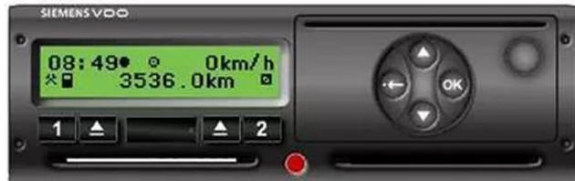
Nakon što nam se prikaže ovakva slika na ekranu stisnemo tipku **OK**. Slijedom toga prikazuje nam se na ekranu *printout, driver 1*.
